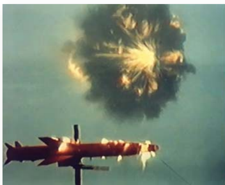
Дејство пројектила 76 mm на макеју ракете (лево) и приказ фрагментационог дејства
